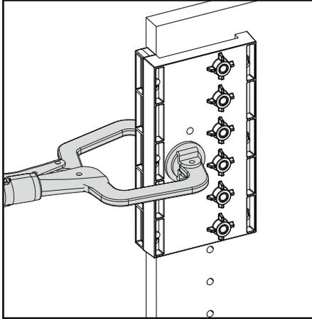
Benytt forlengelser for å plassere jiggen når du skal sette hull der tvingen ikke når frem. Bor det første hull. Skyv sentreringspinnen gjennom boresporet og inn i dette hull for å stabilisere jiggen. Bor resten av de fem hullene.
