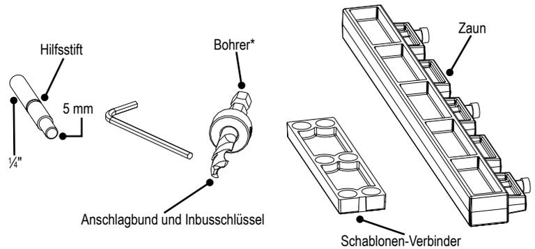
\*(1/4" und 5 mm-Bohrer separat erhältlich.)
