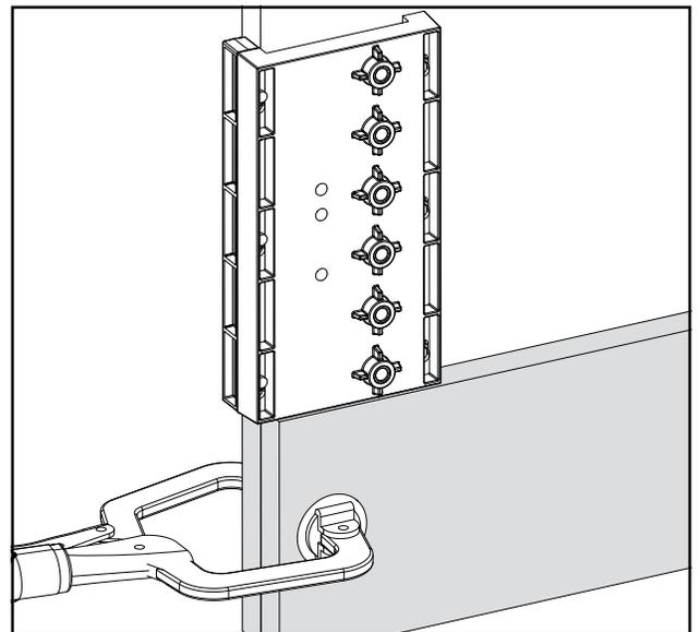
Il arrive parfois que vous n'ayez pas besoin d'une ligne continue de trous espacés de 1/4" [32 mm] au centre. Pour sauter des trous sans perdre l'alignement, suivez les instructions de la section Utilisation de l'axe d'index, mais après avoir repositionné le gabarit, passez quatre trous et ne percez que le dernier. Ensuite, repositionnez le gabarit en insérant l'axe d'index dans ce trou unique et percez les cinq autres trous. Répétez l'opération selon les besoins.
