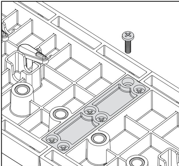
Para asegurarse de que los orificios de sujeción de estantería están perfectamente alineados, fije al lateral del armario un espaciador con los extremos de la base y los lados alineados. Después, apoye la plantilla en el espaciador, fije la plantilla en su sitio y perfore los orificios.
