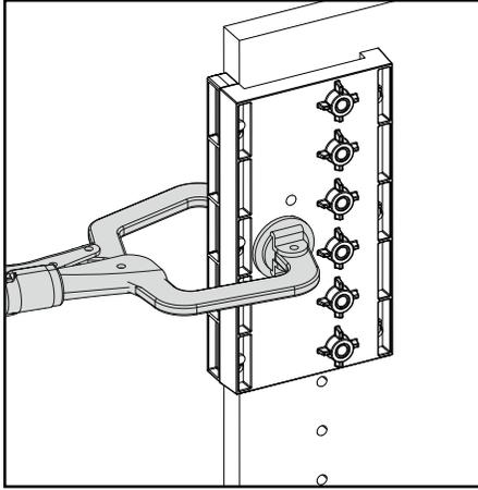
Kun teet reikiä kohtiin, joihin pidike ei ulotu, sijoita laite välikkeiden avulla. Poraa ensimmäinen reikä. Liu'uta jakotappi poran ohjaimen läpi tähän reikään laitteen vakauttamiseksi. Poraa jäljellä olevat viisi reikää.
