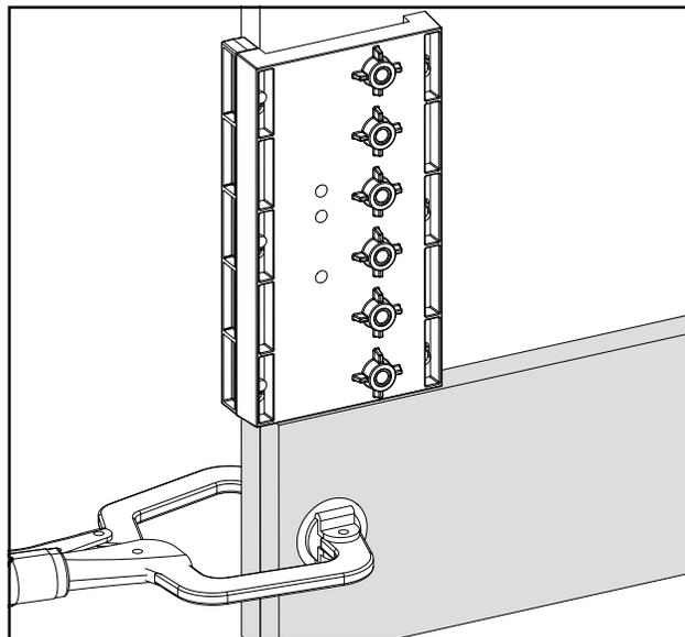
Иногда нет необходимости просверливать отверстия в центре каждые 1/4" [32 мм]. Чтобы пропустить отверстия и не нарушить соответствие, следуйте инструкциям в разделе «Использование позиционирующего штифта», но после перемещения кондуктора пропустите четыре отверстия и просверлите только последнее. Теперь переместите кондуктор с позиционирующим штифтом, вставленным в это единственное отверстие, и просверлите оставшиеся пять отверстий. При необходимости повторите.
