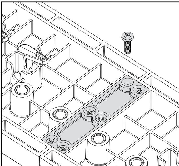
Damit die Regalstift-Löcher an jeder Ecke des Regals perfekt zueinander passen, befestigen Sie einen Abstandhalter an der Regalseite mit der unteren Kante und schieben Sie ihn nach links oder rechts. Setzen Sie die Schablone auf den Abstandhalter, befestigen Sie sie mit einer Klammer und bohren Sie die Regalstift-Löcher.
