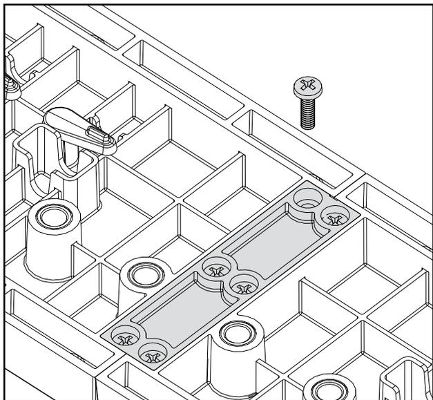
Чтобы обеспечить точное совмещение отверстий для полкодержателей с обеих сторон, закрепите подпорку на стенке шкафа таким образом, чтобы нижние края подпорки и стенки совпадали. Затем поместите кондуктор на подпорку, закрепите зажимом и просверлите требуемые отверстия для полкодержателей.
