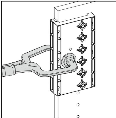
Als er gaten buiten het bereik van de klem liggen, gebruikt u afstandsblokken om de mal te plaatsen. Bore het eerste gat. Schuif de indexeerpin door de boorgeleider en in dit gat om de mal te stabiliseren. Bore de overige vijf gaten.
