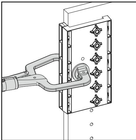
Når du skal placere huller, hvor skruevingen ikke kan nå, kan du bruge afstandsstykker til at placere skabelonen. Bor det første hul. Stik positionsstiften gennem borebøsningen og ned i det borede hul for at stabilisere skabelonen. Bor de resterende fem huller.
