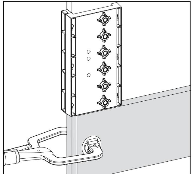
Ocasionalmente não precisa de uma coluna contínua de furos espaçados cada 1/4" [32 mm] no centro. Para saltar furos sem perder o alinhamento, siga as instruções na secção A usar o pino de indexação, mas depois de reposicionar o jig, salte quatro furos e faça apenas o último furo do pino de prateleira. Agora reposicione o jig com o pino de indexação inserido neste único orifício e faça os cinco furos restantes. Repita, se necessário.
