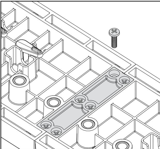
Para garantir que os furos dos pinos das prateleiras em cada canto se alinhem perfeitamente, prenda um espaçador ao lado do armário com as bordas inferiores do espaçador e do nivelador lateral. Em seguida, coloque o jig no espaçador, prenda-o e faça os furos do pino de prateleira.
