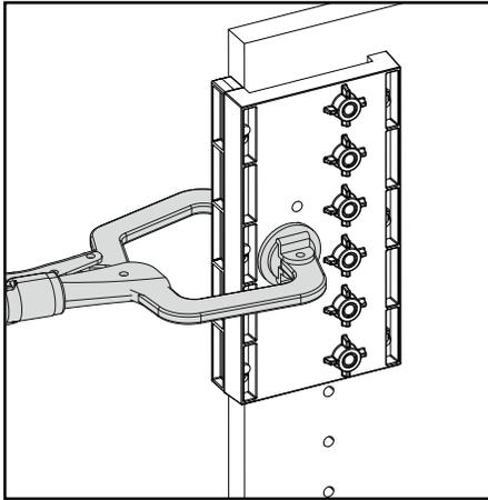
Beim Bohren von Löchern, wo die Klammer nicht hinreicht, verwenden Sie Abstandhalter zur Platzierung der Schablone. Bohren Sie das erste Loch. Schieben Sie den Hilfsstift durch die Bohrhilfe und in dieses Loch, um die Schablone zu stabilisieren. Bohren Sie die übrigen fünf Löcher.
