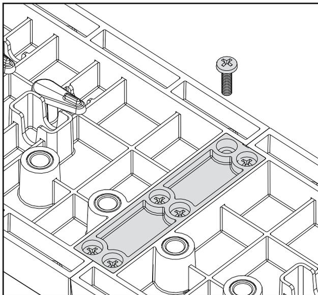
Per assicurarsi che i fori per perni ad ogni angolo della mensola siano allineati perfettamente, fissare un distanziale sul lato contenitore con i bordi inferiori del distanziale e il lato a filo. Dopodiché collocare la maschera sul distanziale, fissare la maschera in posizione e praticare i fori per perni.
