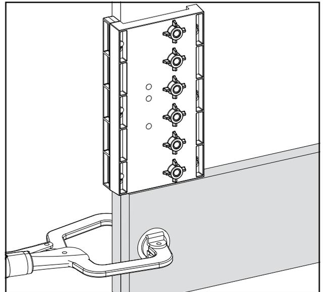
Av og til trenger du ikke hel hullrad med 32 mm avstand [1 1/4"] på senter. For å hoppe over hull uten å miste justering, følg anvisningen i avsnittet om bruk av sentreringspinne, men etter å ha posisjonert jiggen på nytt, hopp over fire hull og bor kun det siste hull. Posisjoner nå jiggen med sentreringspinnen monteret i dette enkelthullet, og bor resten av de fem hullene. Gjenta som nødvendig.
