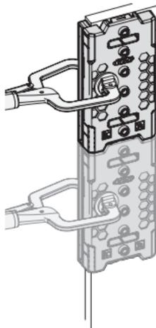
**Tipp** Wenn Ihr Schrank bereits zusammengebaut ist, entfernen Sie die Führung und platzieren Sie die Schablone mit demselben Referenzpunkt wie die Vorderseite an der Rückseite des Schrankes. Halten Sie sie vorsichtig fest, während Sie das erste Loch bohren. Verwenden Sie dann die Schablonenverlängerung und den Indexierstift, um fortzufahren.
