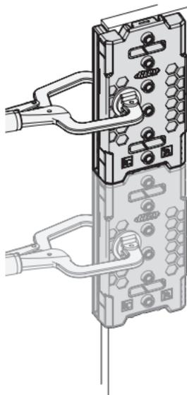
**Consejo** Si su armario ya está ensamblado, retire el soporte guía y coloque la guía contra la parte posterior del armario usando el mismo punto de referencia que en la parte anterior y sosténgala con firmeza en su lugar mientras taladra el primer orificio. Luego, use la extensión de la guía y el pasador de guía para continuar.
