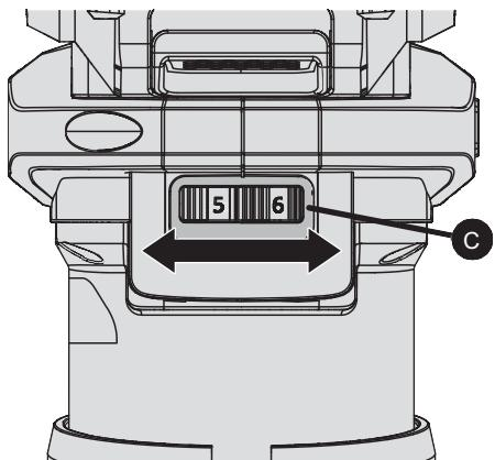
**Nota** Si la herramienta funciona en forma continua a baja velocidad por un periodo de tiempo prolongado, se provocará una sobrecarga en el motor.
