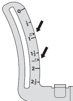
**Consejo** El soporte de profundidad contiene marcas adicionales para indicar la profundidad de corte adecuada cuando se utiliza esta sierra para cortar espesores de material comunes. Utilice el ajuste 3/4 Ply al cortar material común de 3/4 in, como madera contrachapada y tablas de 1x (una por una). Utilice el ajuste 2X MAT'L al cortar material de 1-1/2 in de grosor, como tablas de 2x (de dos en dos).
