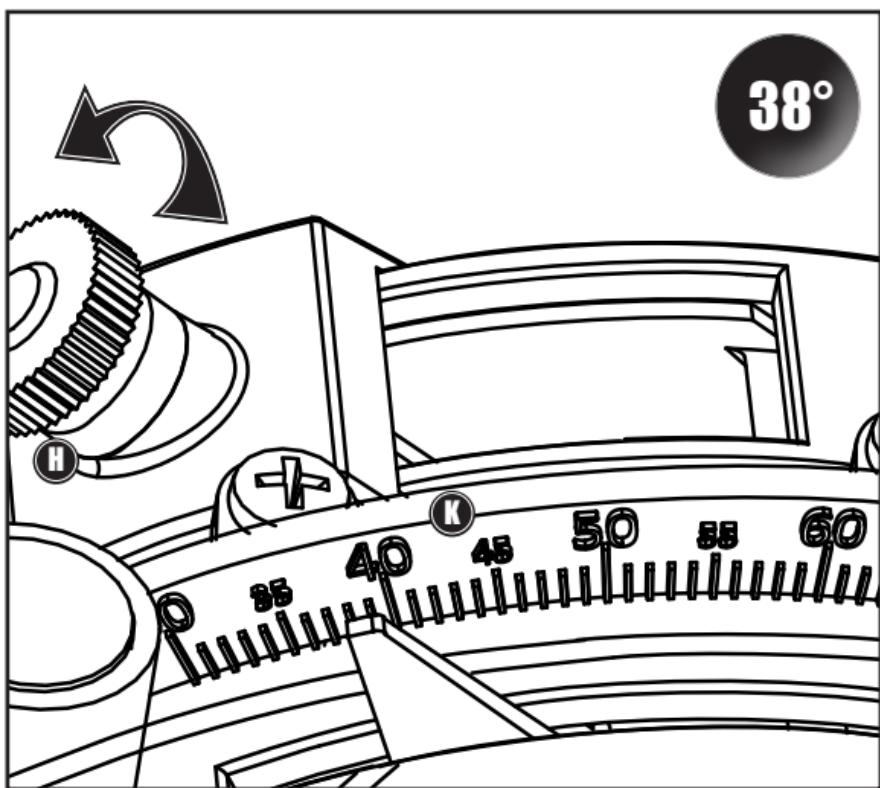
**② Ubique el Crown-Pro™ para que coincida con el ángulo con la pared utilizando la tuerca de ajuste en la parte posterior.**
