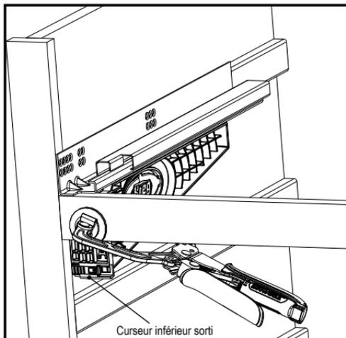
**⚠ ATTENTION** N'allongez pas les curseurs inférieurs quand les rebords intérieurs du cadre sont au même niveau que les côtés intérieurs de l'armoire. Fixez les supports aux côtés de l'armoire au moyen des serre-joints. Assurez-vous que le tampon du serre-joint soit appuyé sur l'armature du support et non sur le treillis central de l'armature, y compris le logo Kreg. Fixer le tampon du serre-joint sur le treillis pourrait briser le support.
