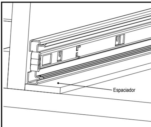
**⚠ ATENCIÓN:** Al instalar los accesorios de gaveta de los deslizadores para gaveta de  $\frac{3}{4}$  de extensión con bridas que se extienden por debajo de los costados de la gaveta, coloque la gaveta boca abajo en el banco de trabajo e instale los accesorios conforme con las indicaciones del fabricante acerca de la distancia de retroceso con respecto al frente de la gaveta.
