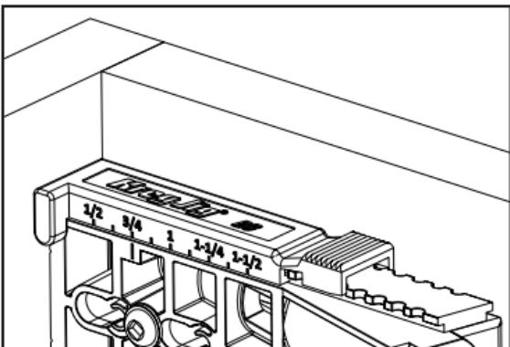
En situaciones en que no es posible sujetar la plantilla en su lugar, fije la plantilla a la pieza de trabajo con un tornillo para madera a través del orificio de montaje. Recuerde ubicar el anillo de detención de la broca para taladro para que coincida con el grosor de la pieza de trabajo.
