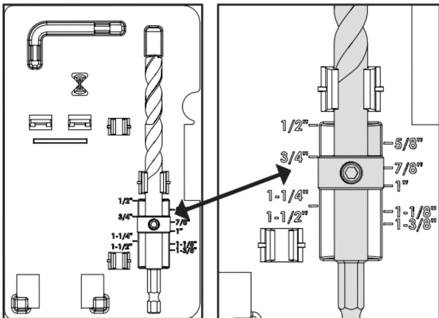
**Dans l'exemple, le collet de butée est positionné pour une pièce de 19 mm (3/4 po) d'épaisseur.**
