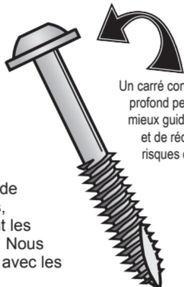
Un carré conducteur profond permet de mieux guider la vis et de réduire les risques de rejet.
