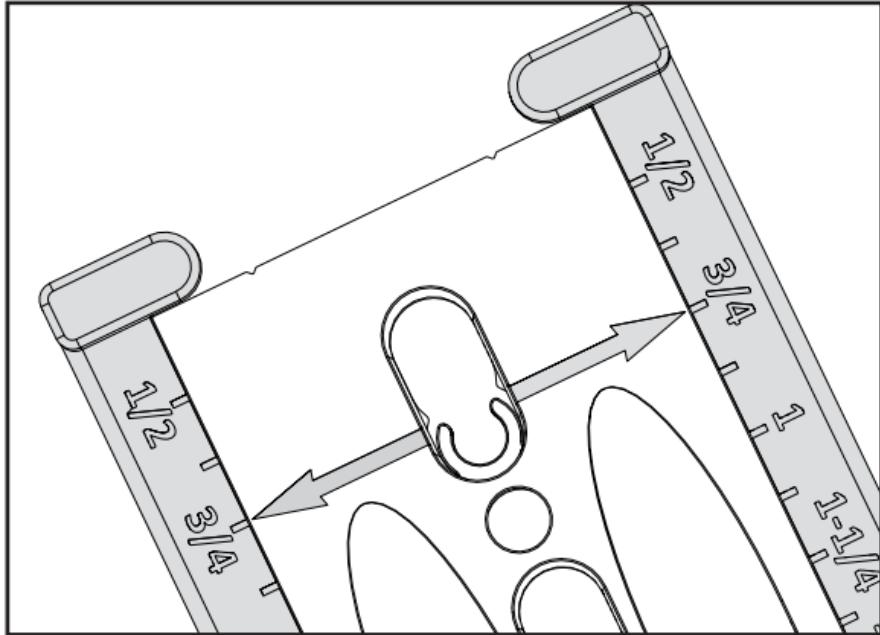
Dans l'exemple, les coulisseaux sont positionnés pour une pièce de 19 mm (3/4 po) d'épaisseur.
