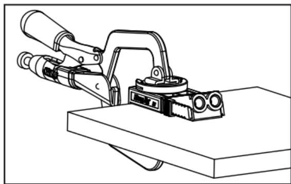
Con el adaptador de la almohadilla de la abrazadera que se incluye, se puede conectar la plantilla Kreg Jig® R3 a cualquier abrazadera face clamp de Kreg para un posicionamiento y una sujeción más rápidos.
