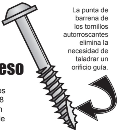
La punta de barrena de los tornillos autorroscantes elimina la necesidad de taladrar un orificio guía.
