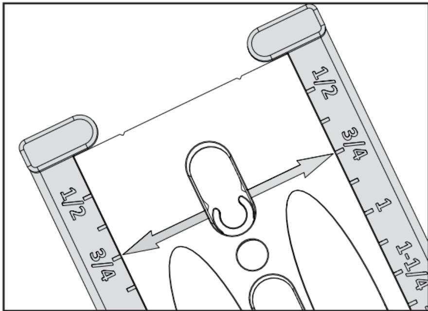
El ejemplo muestra las correderas colocadas para una pieza de trabajo de  $\frac{3}{4}$  de pulgada (19 mm) de grosor.
