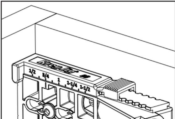
Lorsqu'il n'est pas possible d'utiliser un serre-joint, fixez le gabarit à la pièce travaillée en insérant une vis à bois dans le trou de montage. N'oubliez pas de positionner le collet de butée sur le foret selon l'épaisseur de la pièce travaillée.
