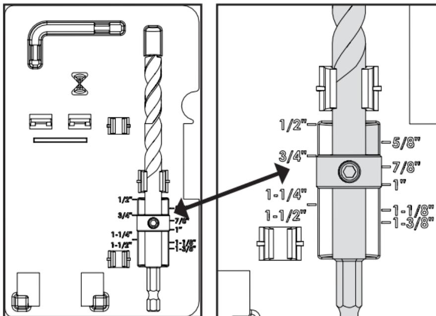
**El ejemplo muestra el anillo de detención colocado para una pieza de trabajo de  $\frac{3}{4}$  de pulgada (19 mm) de grosor.**
